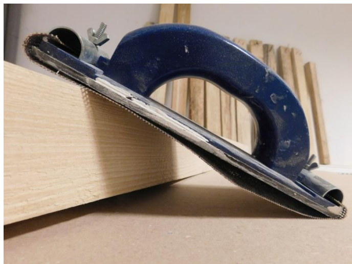
Veškerá prkna i trámky obrousíme vhodným nástrojem. Rychle to jde i brusnou mřížkou č. 80 a dobroušením č. 120
