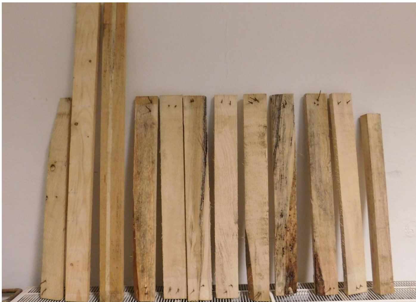
Paletu rozebereme a necháme vyschnout a následně odstraníme i hřebíky
