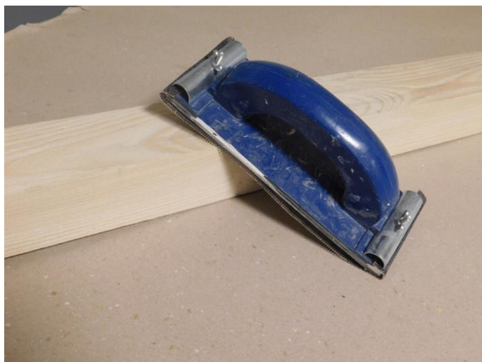
Veškerá prkna i trámky obrousíme vhodným nástrojem. Rychle to jde i brusnou mřížkou č. 80 a dobroušením č. 120
